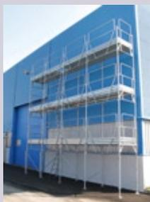
Il nuovo ponteggio a telai SE è progettato secondo la Norma Europea EN12810 per operare con la massima sicurezza. Il parapetto di sicurezza si monta dal piano inferiore già protetto, il telaio parapetto è inoltre dotato di due diverse spine di collegamento: una più lunga e conica di innesto e l'altra più corta di blocco, tutte e due rivolte verso il basso per un montaggio pratico, veloce e facile.
